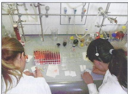
Oszlopkromatográfia közben (lényege: a különböző anyagok eltérő ideig kötődnek az oszloptöltettséghez, így eltérő sorrendben távoznak az oszlopról)
