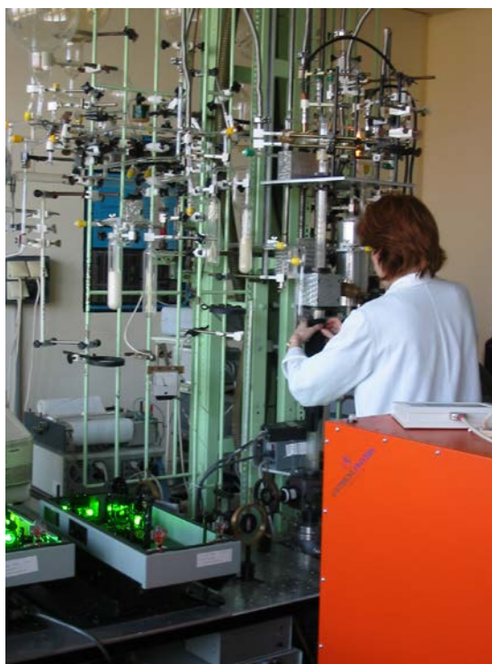
Gázfázisú elemi reakciók vizsgálatára szolgáló, lézerindukálta fluoreszcenciás detektálással összekapcsolt, gyorsáramlásos kinetikai berendezés
