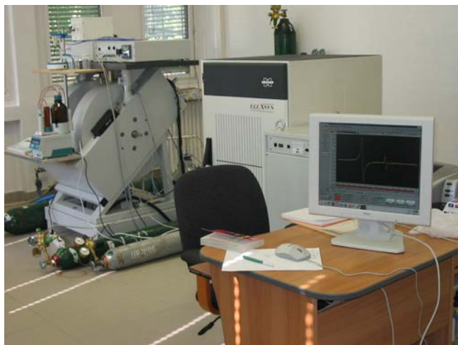
A 2003-ban beszerzett elektronspinrezonancia-spektrométer nanoszerkezetű anyagok vizsgálatára, szabad gyökök, átmenetifém-ionok biológiai szerepének kutatására
