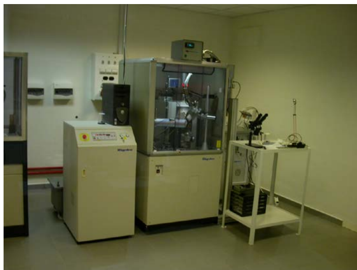
A 2004-ben üzembe állított Rigaku R-AXIS RAPID diffraktométer, amellyel fehérjék térszerkezete is meghatározható
