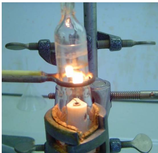
3. ábra Iridium egykristány előkészítése méréshez: 2000 Co-os hevítés argonáramban
