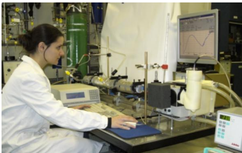
2. ábra Saját műszerfejlesztéssel készült UV-VIS spektrométer gázminták abszorpciós spektrumának meghatározására
