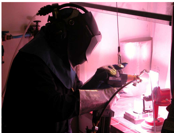
Kerámia bevonat előállítása az AKI termikus plazma laboratóriumában atmoszférikus plazmaszórással
