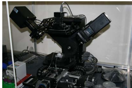
2. ábra: Woollam M2000-DI spektroszkópiai ellipszométer
