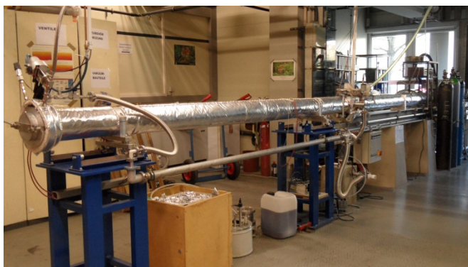
1. ábra A lökéshullámcső berendezés (ST)
