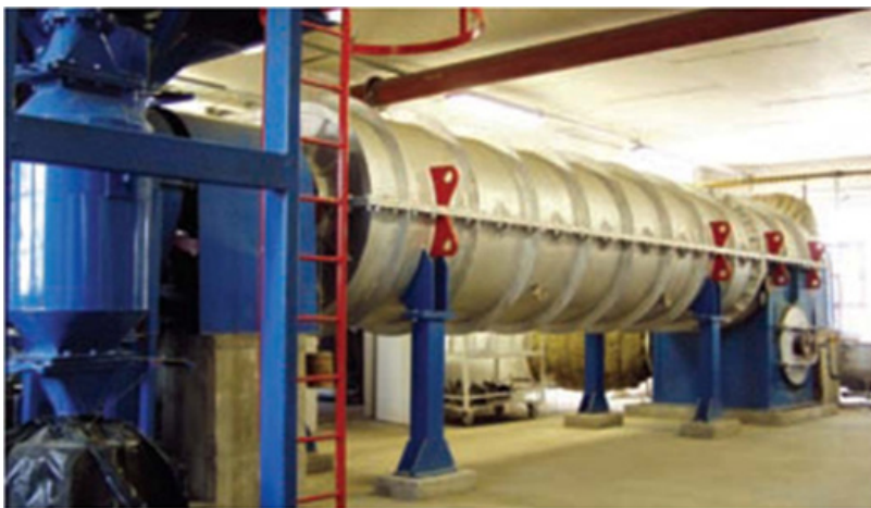
A Terra Humana Kft. horizontális forgódobos kemence típusú pirolizáló ipari berendezése (Polgárdi, Fejér megye)
