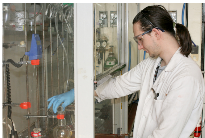
Amfifil kotérhálók duzzadási tulajdonságának vizsgálata
