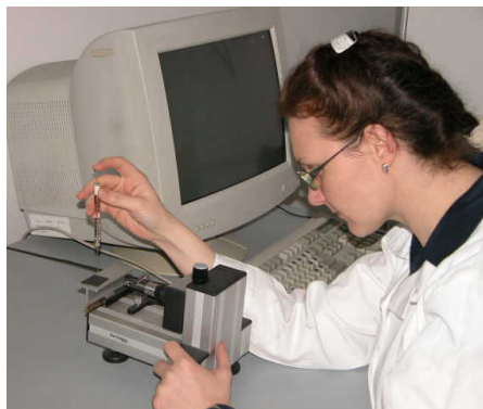
Nedvesedési peremszög mérése és a polikarbonát peremszögei
