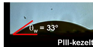
Nedvesedési peremszög mérése és a polikarbonát peremszögei
