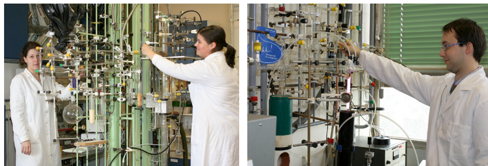
Légkörkémiai kinetikai kísérlet gyorsáramlásos reakciókinetikai berendezésben
