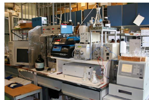
Multidetektoros gélpermeációs kromatográfias berendezés polimerek molekulatömeg-eloszlásának és átlag molekulatömegének meghatározására
