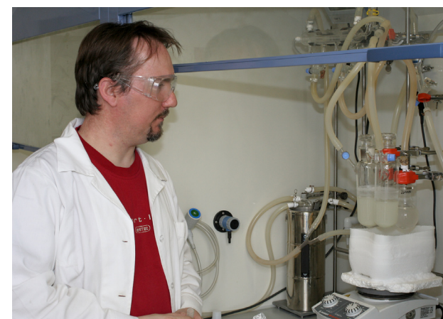
Metakrilát típusú polimerek előállítása ATRP módszerrel
