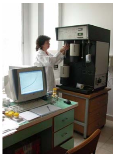
Termikus plazmában előállított összetett oxidok jellemzése ICP-OES (bal oldalon) és BET fiziszorpciós (jobb oldalon) módszerekkel.
