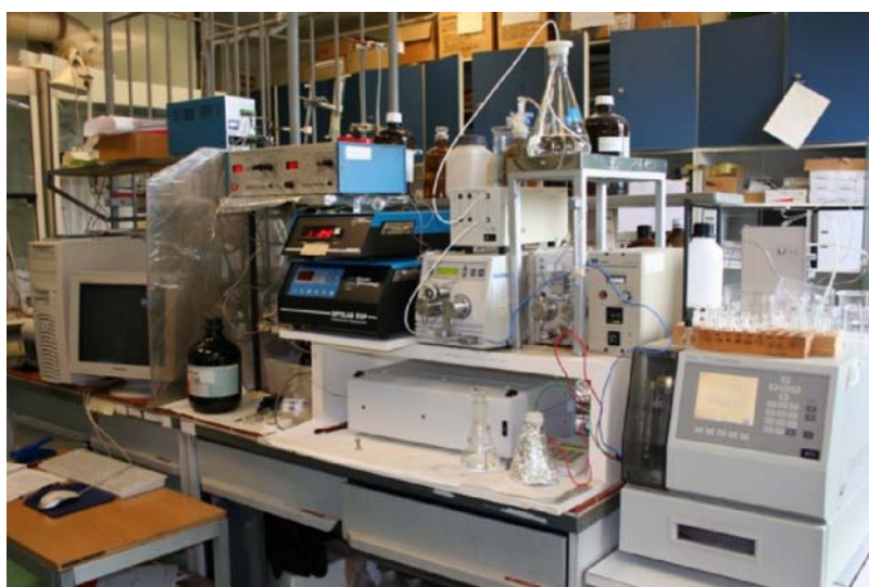
Multidetektoros gélpermeációs kromatográfiás berendezés polimermolekulatömeg-eloszlásának és átlag molekulatömegének meghatározására.
