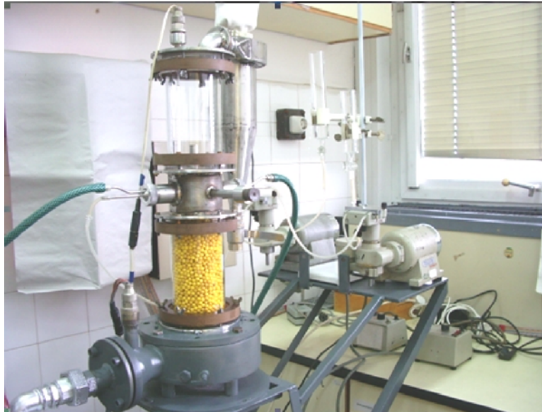
Mechanikus gejszárító inert töltettel
