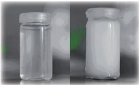
6. ábra Hőmérsékletérzékenység vizsgálata
