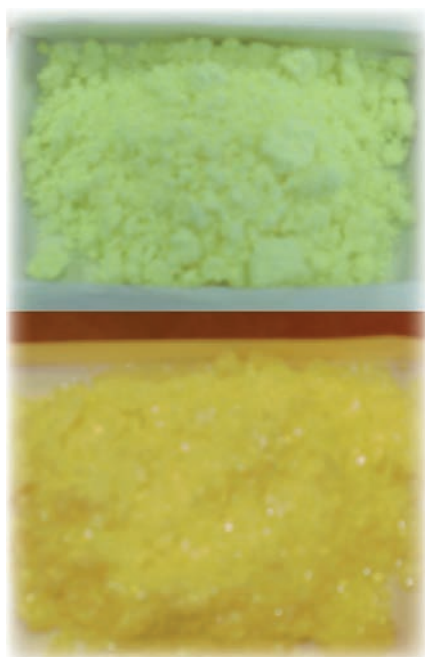
7. kép Az előállított DBA átkristályosítás előtt (felső kép) és után (alsó kép)
