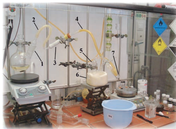
4. kép A DIMCARB szintéziséhez használt berendezés
