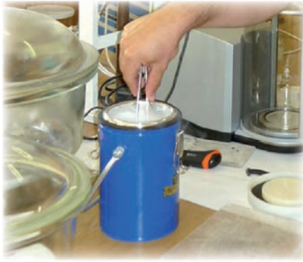
10. ábra Minták törése a SEM vizsgálathoz
