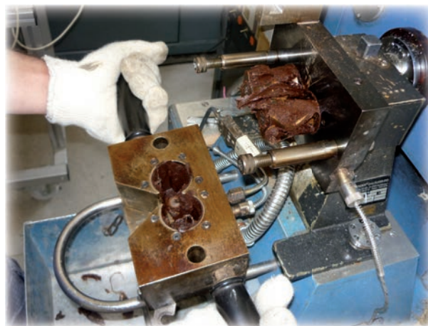
4. ábra Belső keverő - benne a PP(per)lignin keverék
