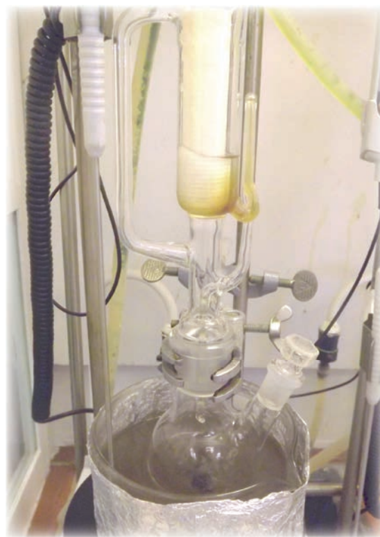
7. kép Soxhlet-extraktor a hűtőberendezés nélkül
