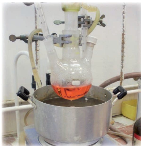
1. kép A \text{Pd(PPh}_3)_4 előállítása - a reakcióelegy kitisztult
