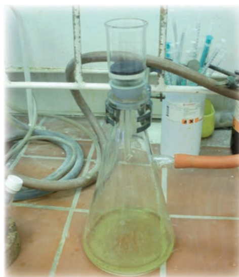
8. kép A Pd_2(dba)_3 vákuumszűrése
