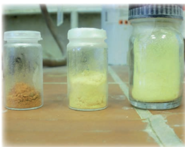
2. kép A \text{Pd(PPh}_3)_4 oxigénérzékenysége. A jobb szélsőt mi állítottuk elő, a többi korábban készítették.
