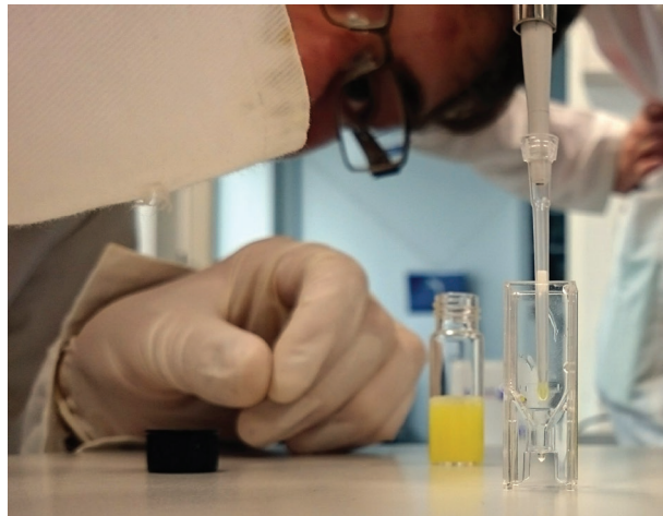
4. ábra Minta kimérése küvettába DLS mérés előtt
