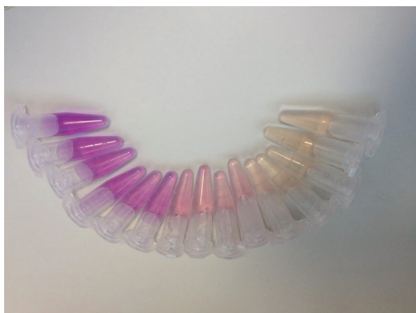
8. ábra: Szív \text{Ca}^{2+} tartalmának meghatározása kolorimetriával
