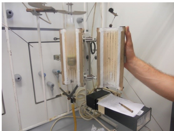
2. ábra Nitridálás kemencében
