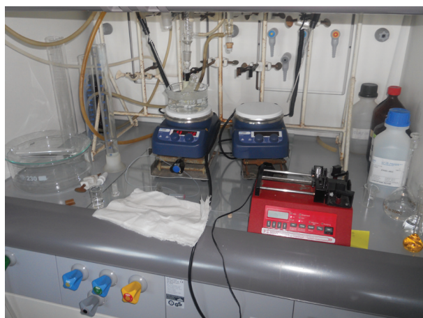
6. ábra Platina leválasztása „ in situ ” kolloidképzéssel
