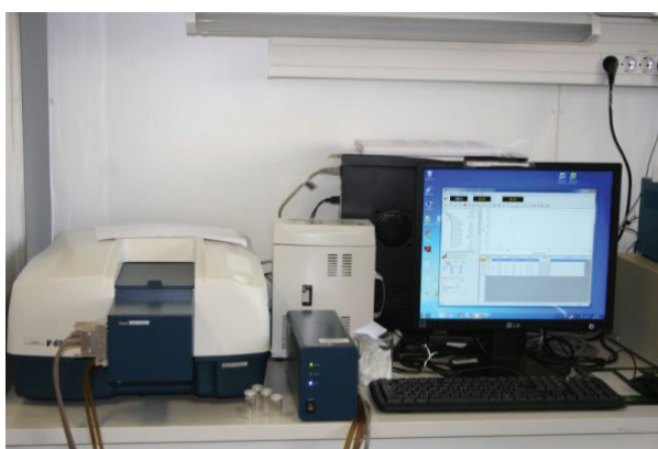
5. ábra Az UV-látható spektroszkóp, mellyel a polimerek vizes oldatának átlátszóságát vizsgáltuk
