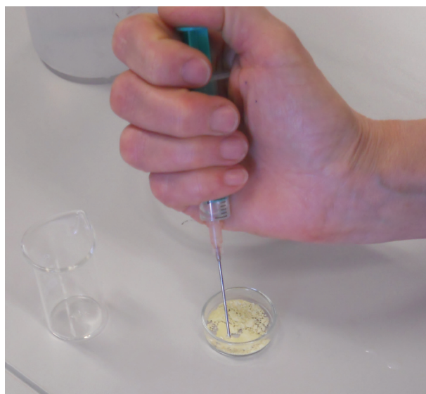
7. ábra Platinafelvitel „száraz impregnálással”
